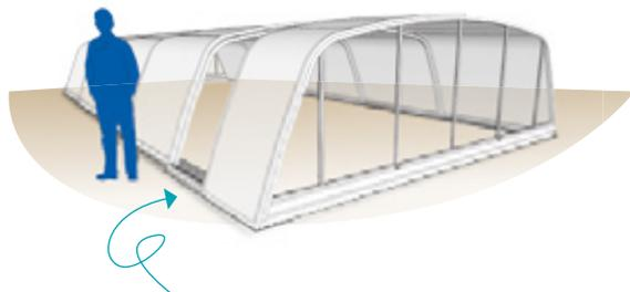
Porte coulissante latérale sur le plus grand élément permettant de pénétrer dans l'abri sans déplacer les éléments.
