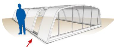
Porte coulissante latérale sur le plus grand élément permettant de pénétrer dans l'abri sans déplacer les éléments.
